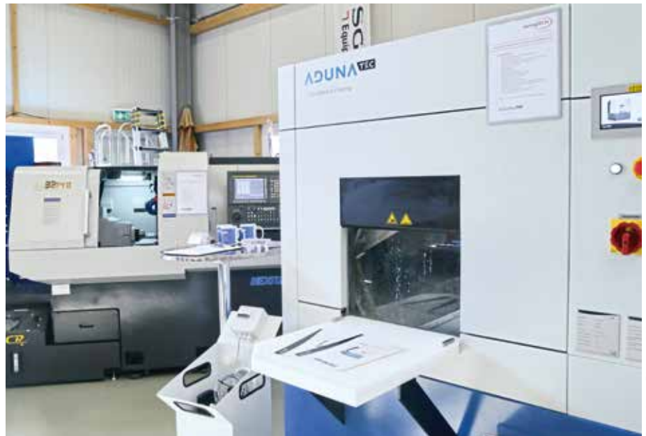
Mitveranstalter Damagtech zeigt einen Nexturn-Langdrehautomaten für anspruchsvolle Drehteile und die kompakte Aduna-K90-2-Bad-Teilereinigungsanlage mit Ultraschall.
